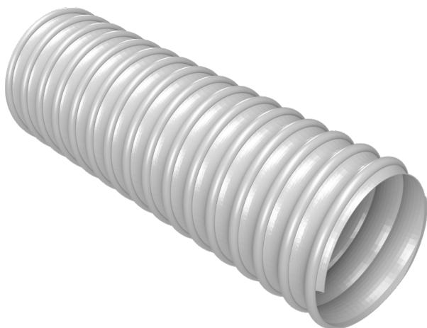
Condotto flessibile con trattamento interno antimicrobico e antivirale, termoisolante e autoportante, diametro 125/160/200. Realizzato in polietilene reticolato ed espanso a cellule chiuse e spirale in acciaio armonico. Rivestimento di protezione interno ed esterno con film di resine poliolefiniche. Reazione al fuoco cl. B-s1, d0 (EN 13501-1:2019)
